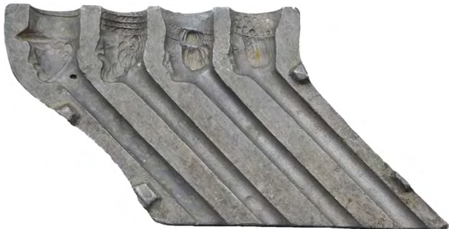
Afb. 31. Rechterhelft van een vergelijkbare vorm met vier sluitnokken. Collectie en foto Ewout Korpershoek.
