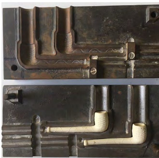
Afb. 25. Mal van de volautomatische machine. Foto en collectie auteur.
